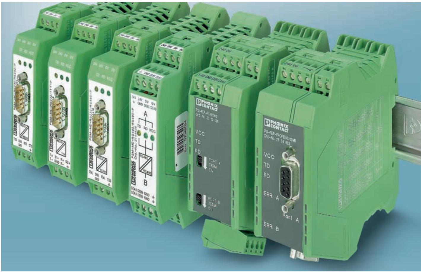
来自菲尼克斯电气的新型 PSI-REP... 系列中继器，是为 PROFIBUS, MODBUS 和其它很多 RS-485 系统实现结构化安装而设计。可自由选择安装元件，通过选用不同的有源中继器，可搭建总线型、星型、树型结构系统。因此，中继器能单独使用，也可以安装在网络中某个节点，作为集线器使用。
